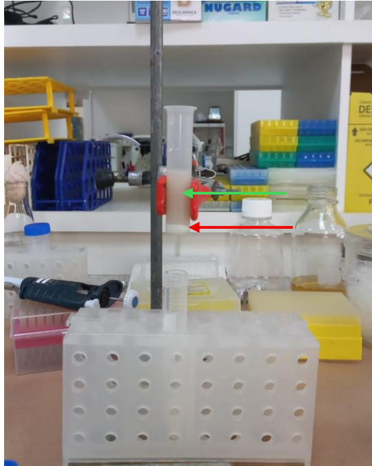
Figura 16. Sistema de purificação de proteínas recombinantes por cromatografia de afinidade com íons metálicos imobilizados (IMAC). A seta verde representa o lisado filtrado, enquanto a seta vermelha indica a resina com o agente quelante e íons metálicos. Fonte: Arquivo Pessoal.
