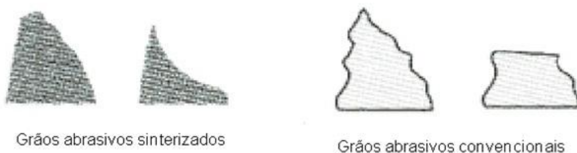
Figura 3 – Grãos abrasivos sinterizados e convencionais
