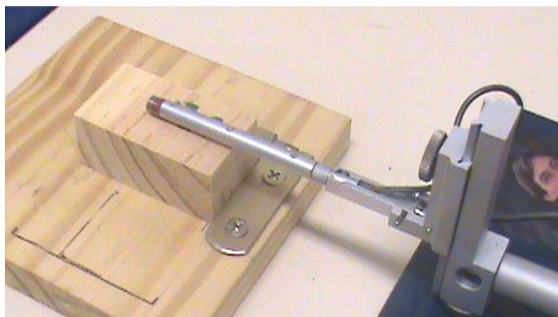
Figura 11 – Medição de rugosidade através do rugosímetro.
