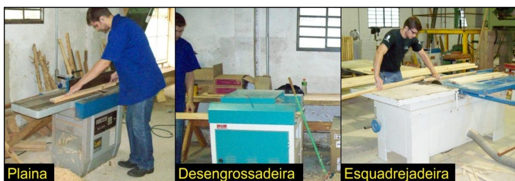
Figura 4 – Processo de preparação dos corpos de prova
