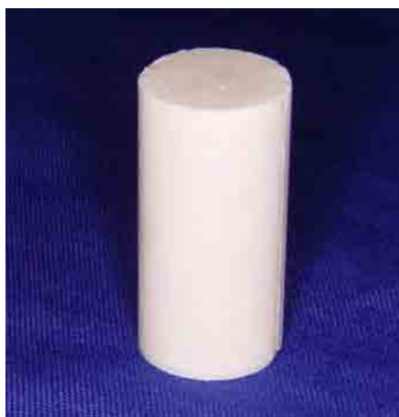
FIGURA 4: Corpo-de-prova do gesso Fuji Rock EP obtido para o ensaio de resistência à compressão.
