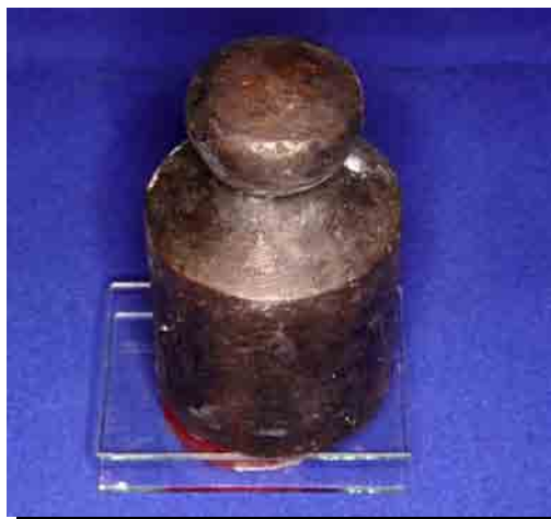
FIGURA 6: Massa de 1 Kg colocada sobre as matrizes após vazamento.
