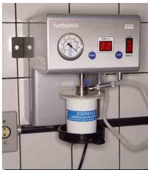
FIGURA 3: Cuba metálica adaptada ao espatulador mecânico e pronta para iniciar a espatulação.
