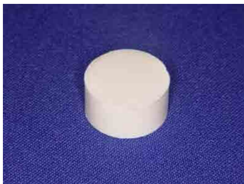
FIGURA 7: Corpo-de-prova do gesso Fuji Rock EP obtido para o ensaio de resistência à tração diametral.
