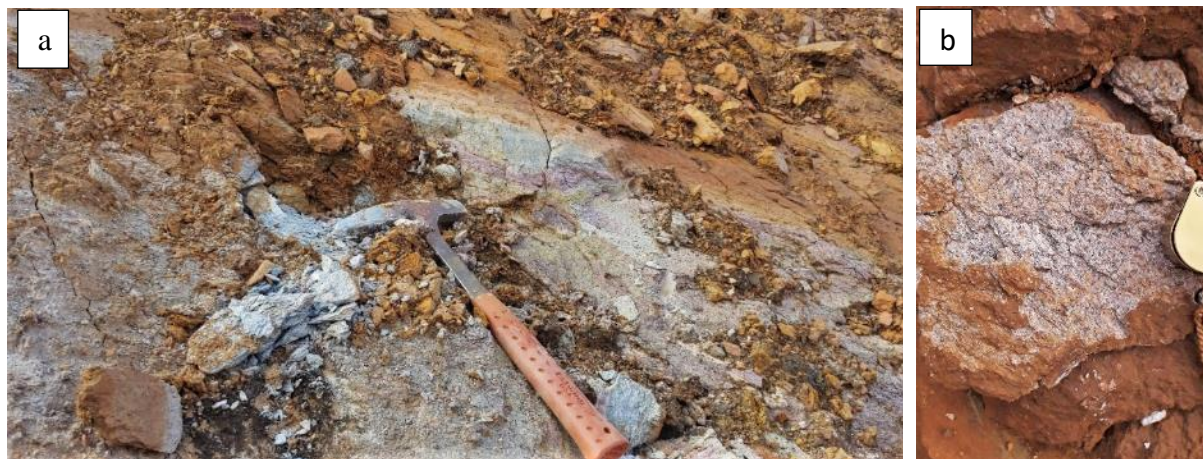
Figura 51. Rocha com coloração cinza-azulada clara a lilás, intensamente intemperizada, proeminentemente xistosa (banco 1040 da região EX) (a) e Amostra de mão (b).
