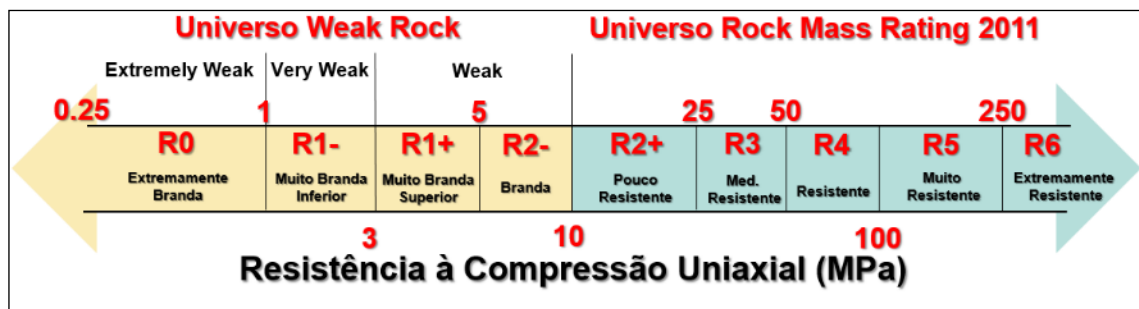
Figura 37. Sistema de classificação geomecânica utilizada na mina de Brucutu. Fonte: Vale, (2019).
