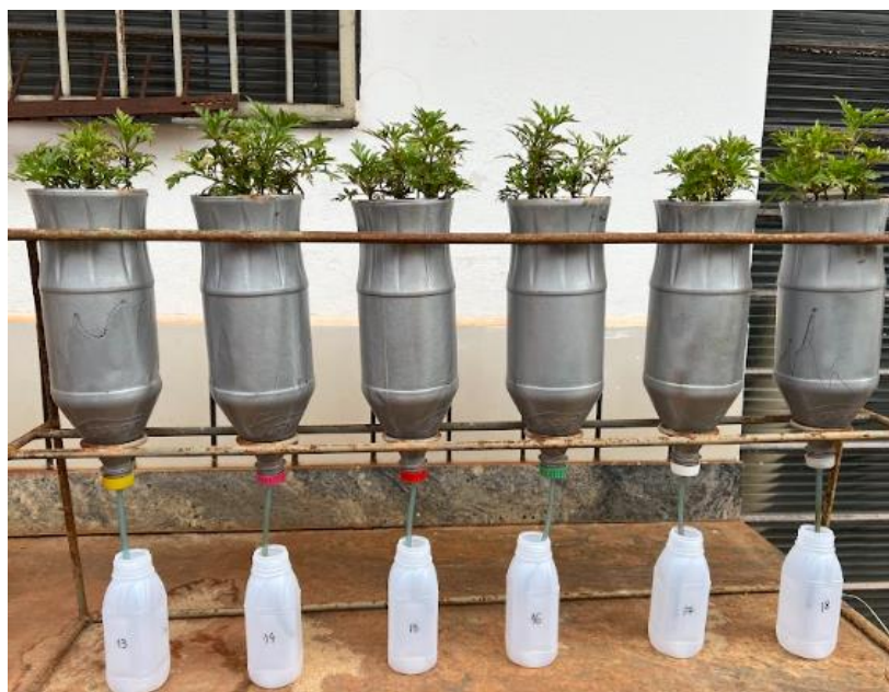
Figura 1. Sistema de garrafas invertidas utilizado para coleta dos exsudatos radiculares de Cosmos sulphureus
