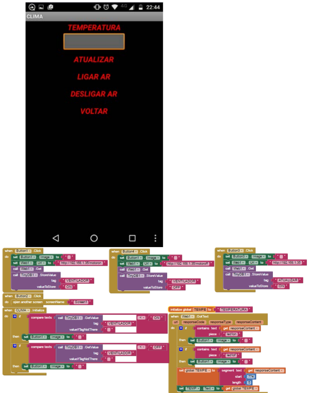
Figura 22 - Layout e programação, tela clima do aplicativo para controle de temperatura na residência
