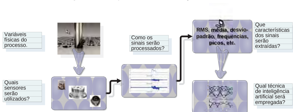
Figura 19 - Método genérico para o desenvolvimento de um sistema de monitoramento inteligente para processos de usinagem. Adaptada de Abellan-Nebot e Subirón (2009).
