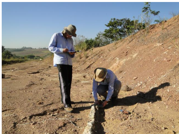
Figura 2.1. Medições das atitudes dos diques clásticos utilizando uma bússola Clar.
