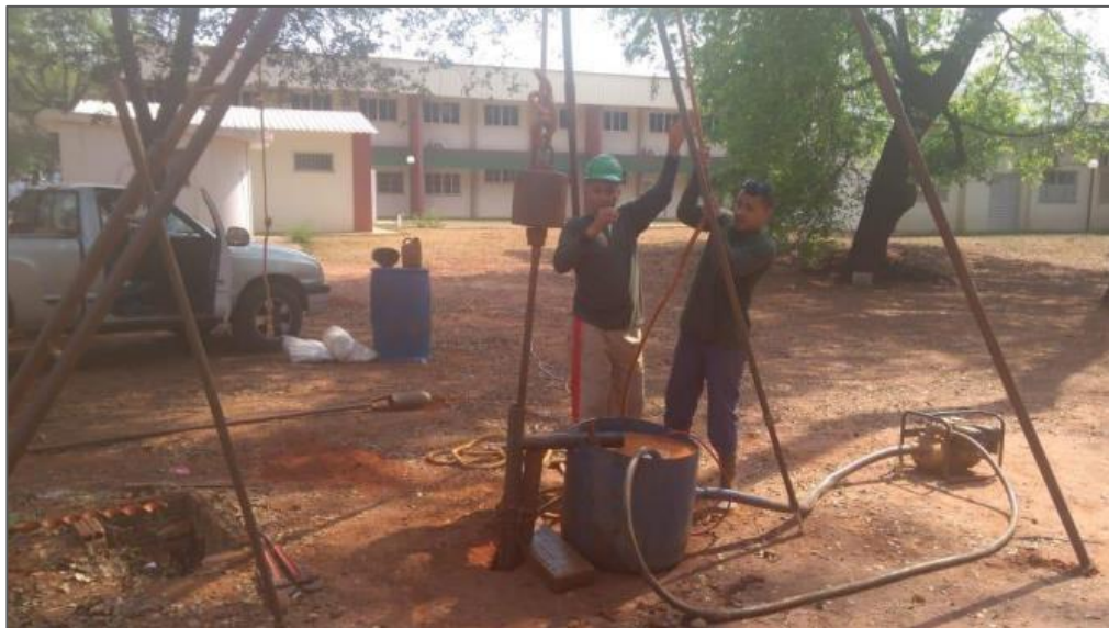
Figura 19 - Ensaio SPT – Parte 03.
