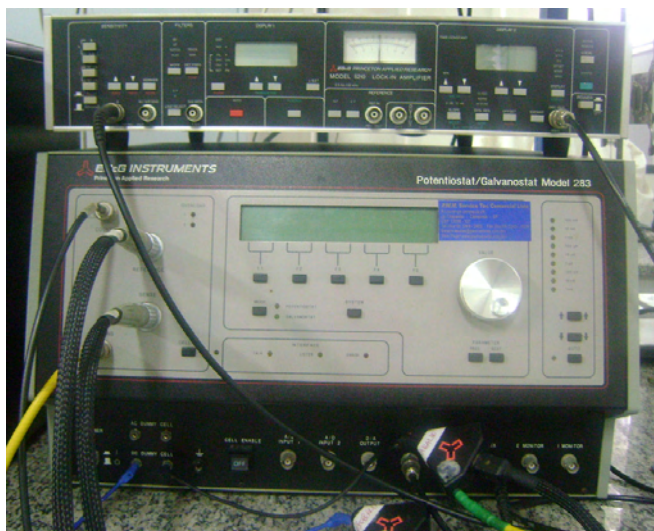
Figura 35 – Potenciostato/galvanostato EG&G PAR, modelo 283, utilizado no ensaio de polarização.
