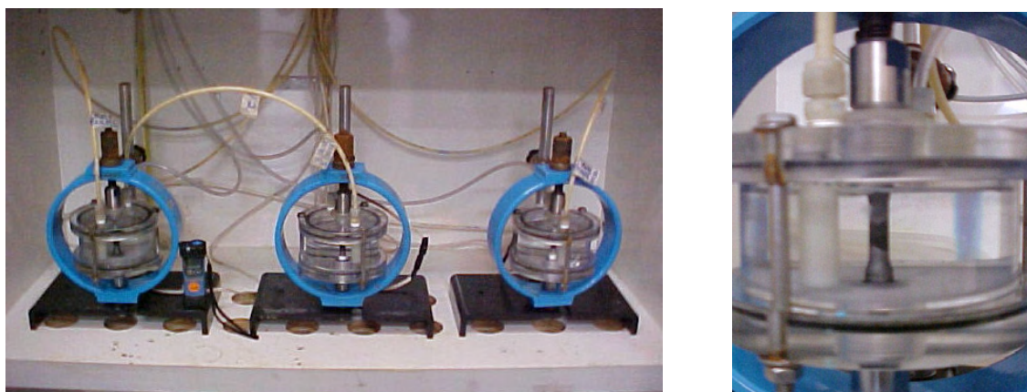
Figura 34 – Montagem / dispositivos para realização do ensaio de SSC.
