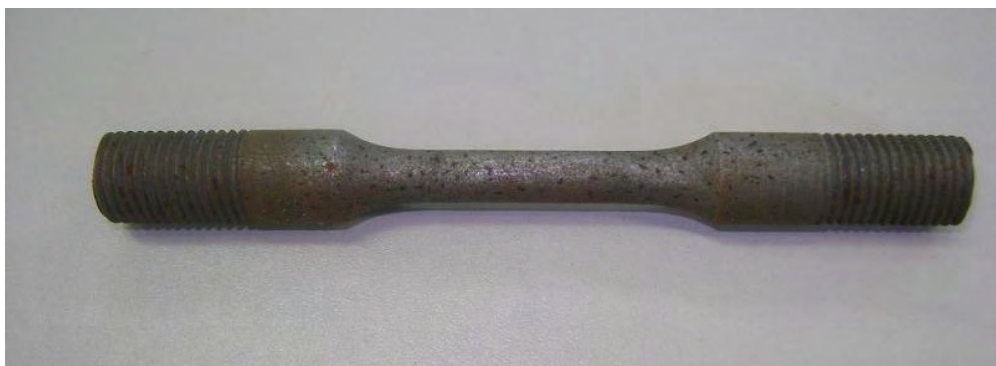
Figura 45 – Amostra de aço API 5L X65 após 720 horas de teste de SSC.
