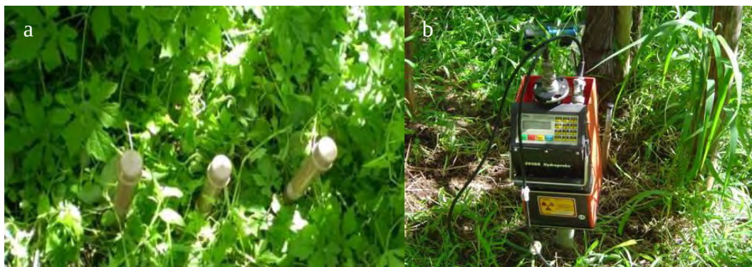
Figura 3. Tensiômetros nas profundidades de 0,2 m, 0,4 m e 0,6 m (a); Sonda de nêutrons utilizada para o monitoramento da umidade do solo nas profundidades de 0,15; 0,30; 0,45; 0,60; 0,75; 0,90; 1,05 e 1,20 m (b).
