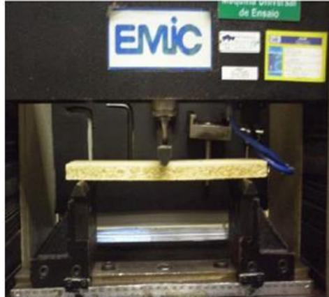
Figura 32 – Ensaio de flexão estática realizado para a determinação do módulo de elasticidade e ruptura.
