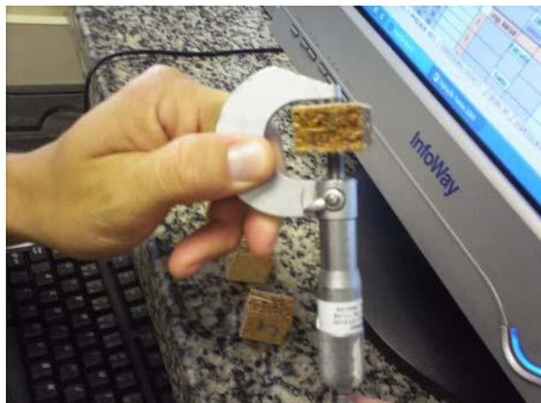
Figura 33 – Medição com micrômetro do corpo-de-prova de inchamento.
