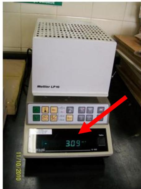
Figura 14 - Equipamento para análise do teor de umidade.
