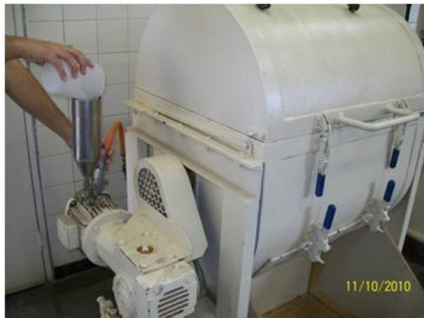
Figura 18 - Adesivo sendo aplicado nas partículas pelo aspersor na encoladeira.
