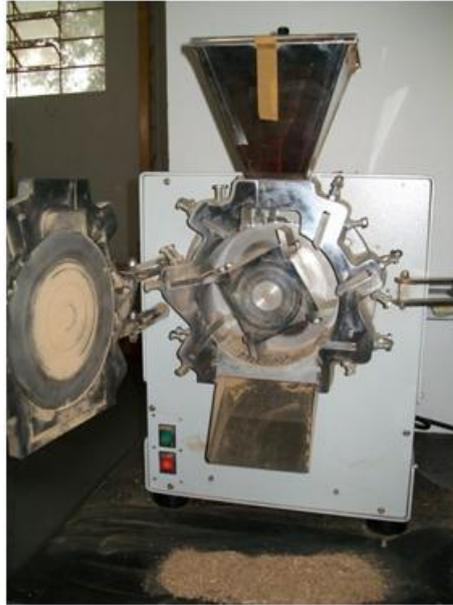
Figura 11 - Moinho do tipo martelo para processamento de madeira.
