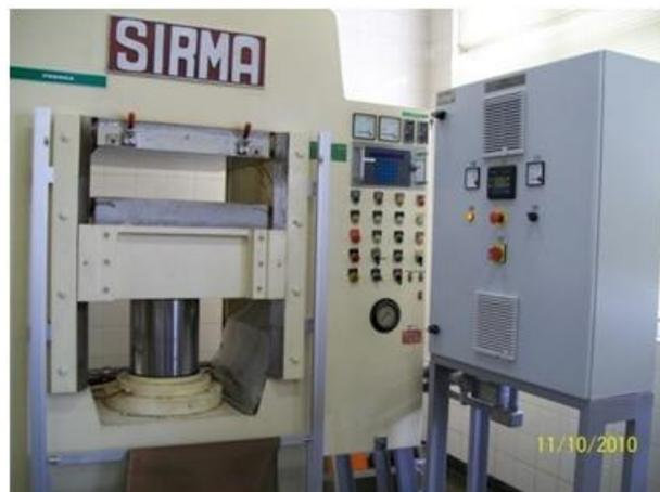
Figura 24 - Prensa utilizada para a fabricação dos painéis de amostra.
