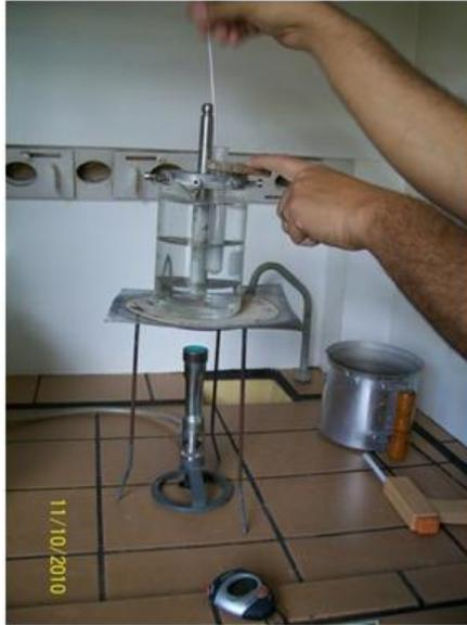
Figura 17 - Teste "Gel Time".
