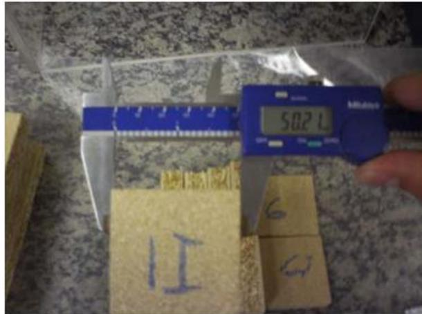
Figura 29 - Paquímetro digital utilizado nos teste para medir as dimensões das amostras.
