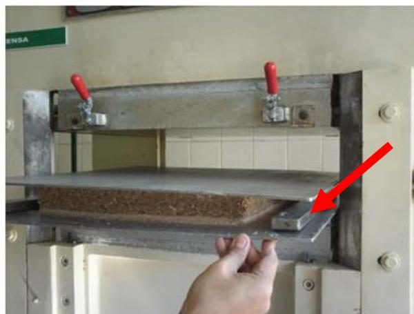
Figura 25 - Colchão com as barras laterais sendo levado à prensa.
