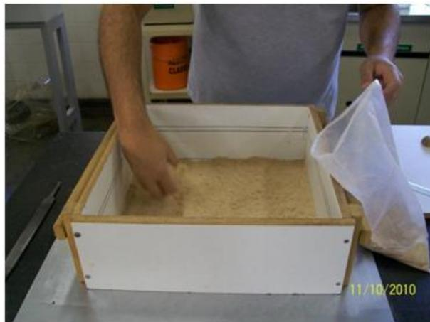
Figura 19 - Formação da camada externa do painel de MDP.
