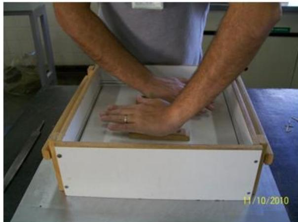
Figura 21 - Tampa de madeira compactando o colchão.
