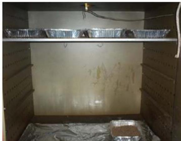
Figura 13 - Recipiente de alumínio com cavaco de bracatinga dentro da estufa.
