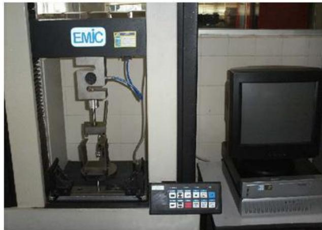
Figura 30 – Máquina universal de ensaios – marca EMIC.
