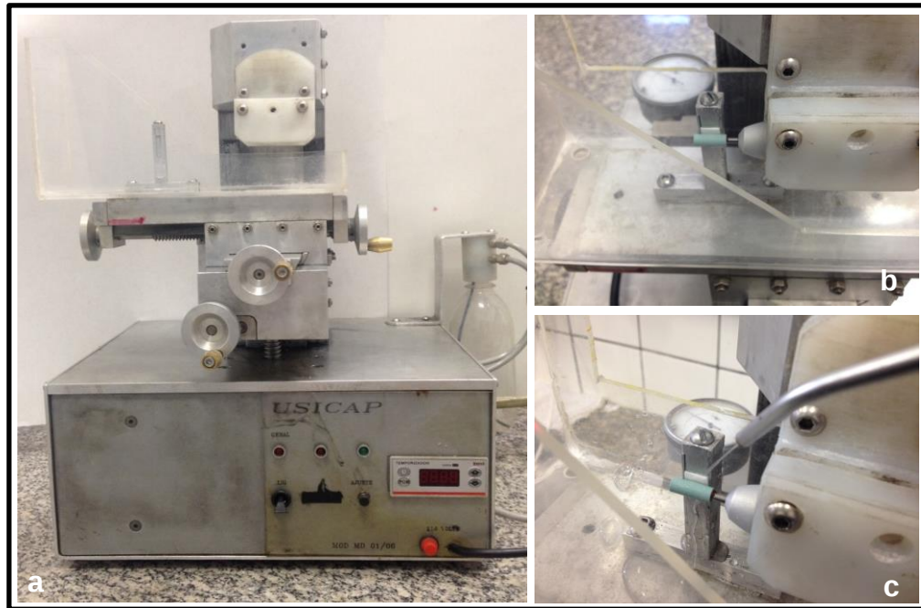
Figura 1- a) Máquina de desgaste, b) desgaste sem irrigação e pedra diamantada, c) desgaste com irrigação e pedra diamantada
