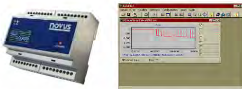
Figura 07. Imagem ilustrativa demonstrando o hardware e do software utilizados na aquisição e exportação dos dados. Fonte: Novus.
