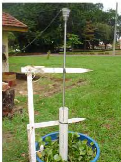
Figura 06. Fotografia demonstrando a disposição do sensor dentro da caixa d'água e também o sistema de fixação dos sensores através de uma estrutura de madeira e do cano de PVC. Ilha Solteira / SP, 2007.
