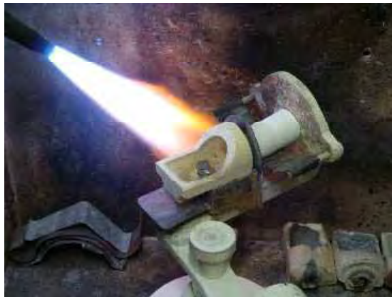
Figura 5. Fundição em liga de ouro de pilar Gold UCLA dos grupos I e II.
