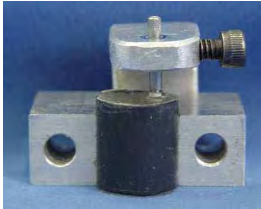
Figura 1. Matriz metálica para embutimento do implante em resina acrílica no interior de um cilindro de PVC.
