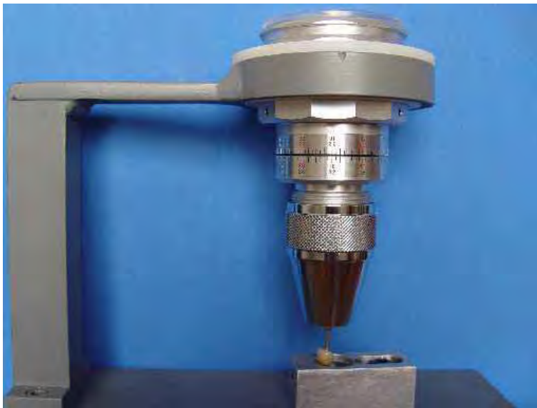
Fig 3. Dispositivo para posicionamento do corpo-de-prova e medidor analógico de torque para aplicação do torque de inserção e mensuração do destorque.
