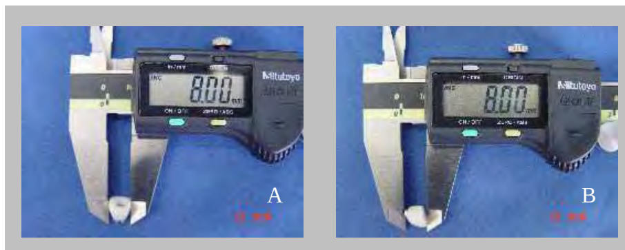
Figura 13. Avaliação das dimensões finais das coroas com 8,0mm no maior diâmetro (A) e 8,0mm em altura (B) após aplicação dos materiais de recobrimento estético.
