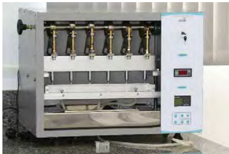
Figura 21. Equipamento eletromecânico de ensaio de fadiga para realização da etapa de ciclagem mecânica.
