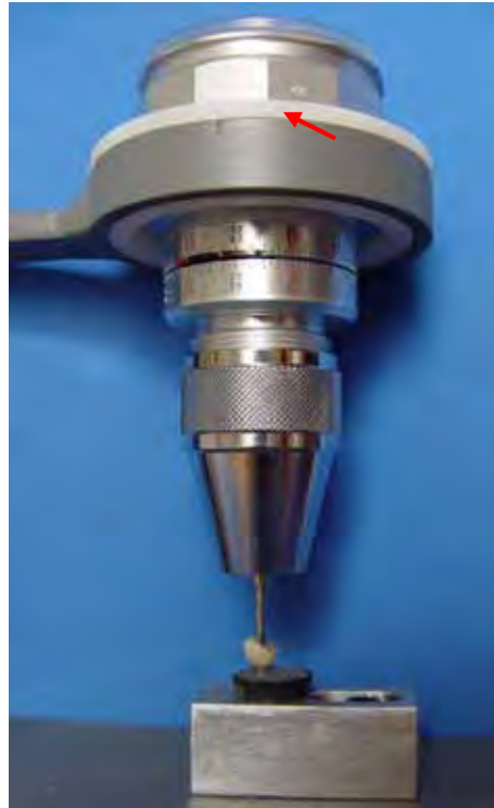
Figura 20. Medidor analógico de torque e corpo-de-prova posicionados para aplicação de torque/mensuração de destorque. Evidenciada pela seta, a bucha de nylon do dispositivo que permite movimentação da porção superior do torquímetro.
