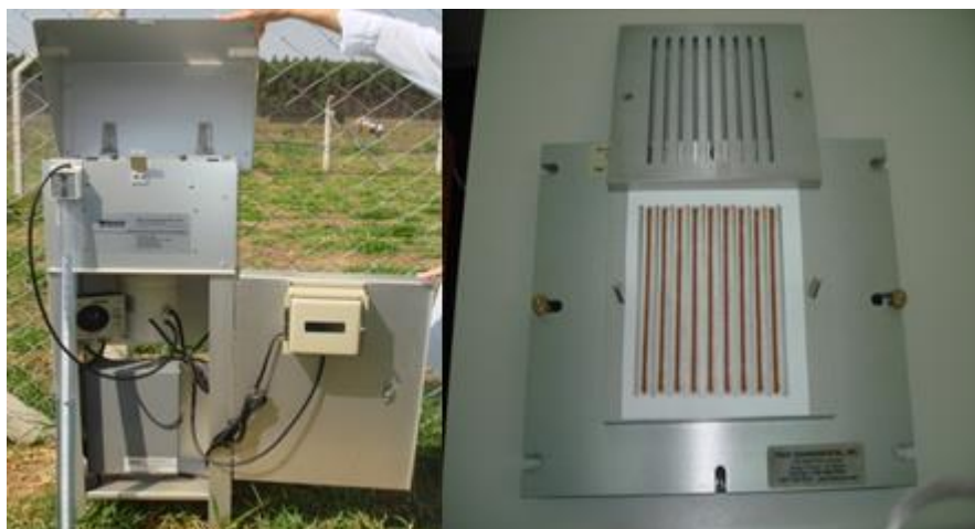
Figura 7. Coletor de grande volume. (a) Coletor de grande volume em funcionamento (b) Placas de impactação em detalhe.
