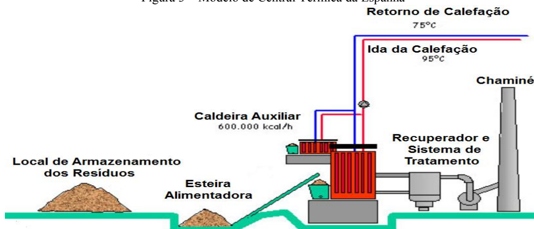
Figura 3 – Modelo de Central Térmica da Espanha
