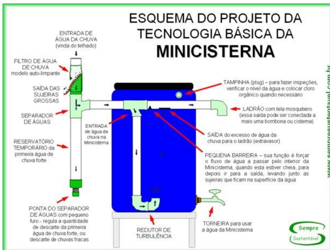
Figura 14: Esquema de funcionamento de um sistema de minicisterna. Fonte: Sempre Sustentável (2016)
