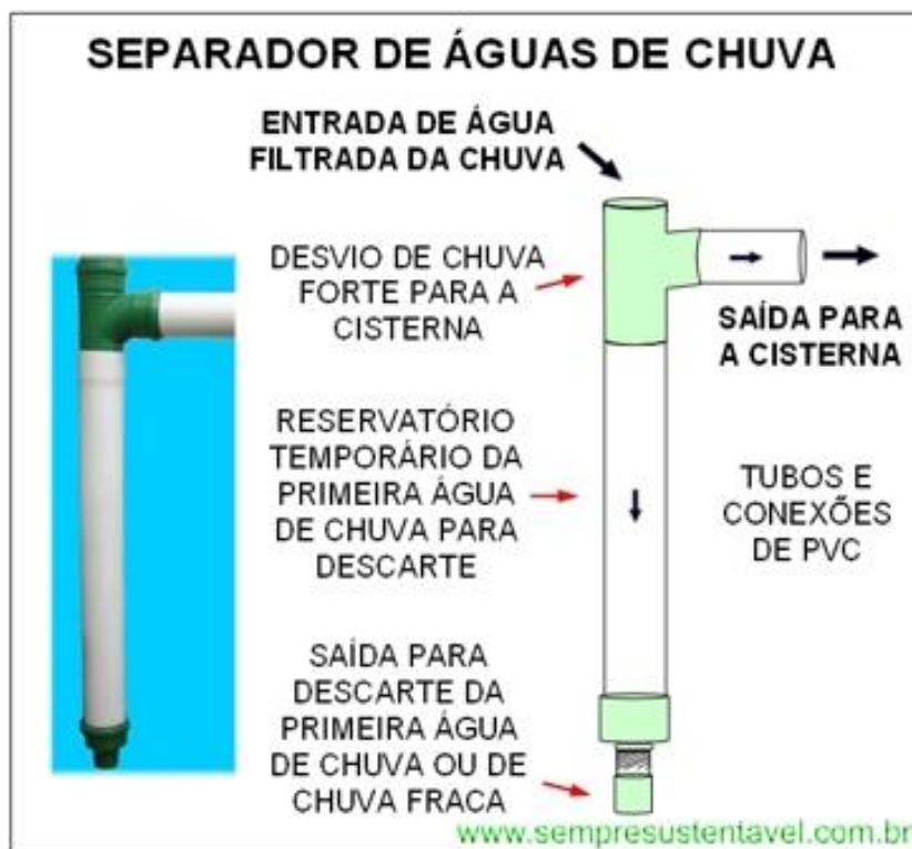
Figura 13: Esquema de separador de águas de chuva. Fonte: Sempre Sustentável (2016)
