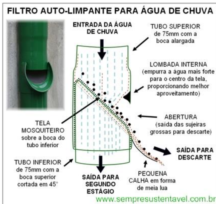
Figura 12: Esquema de filtro auto-limpante para água de chuva. Fonte: Planeta Sustentável (2016)
