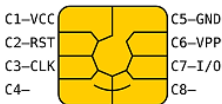
Figura 11 - Pinagem definida pela norma ISO7816
