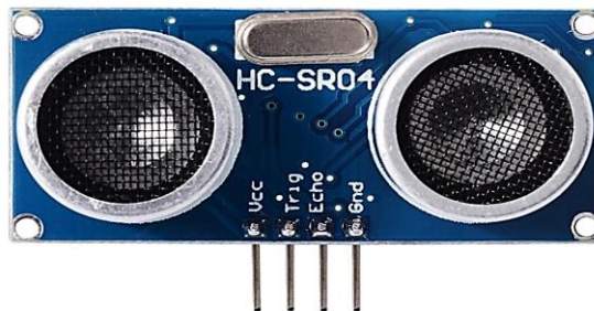
Figura 37 - Modelo de sensor ultrassônico HC-SR04 tradicionalmente utilizado no arduino
