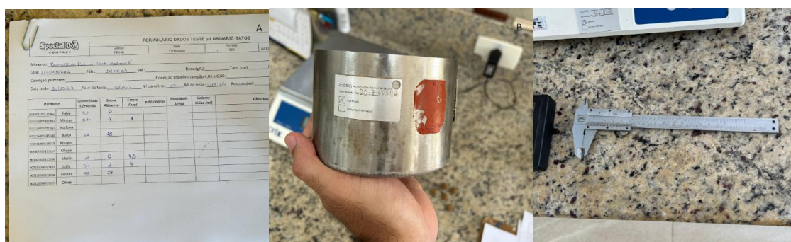
Figura 8 – A. Anotações sobre o teste de Aceitabilidade. B. Recipiente para avaliar a densidade da ração. C. Paquímetro para avaliar tamanho das partículas da ração.
