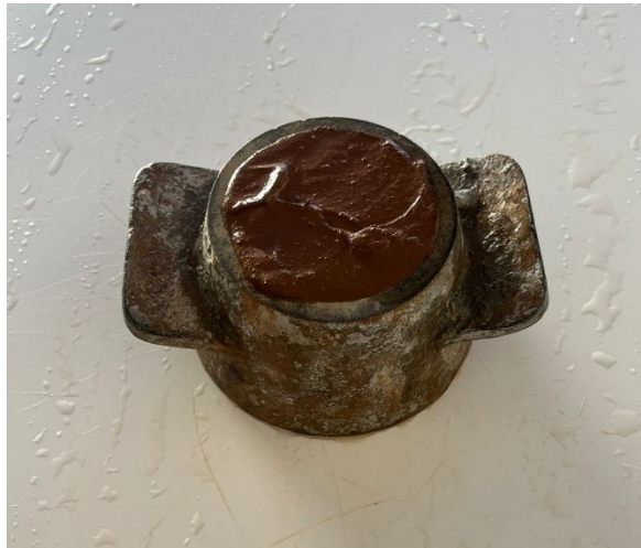
Figura 2 – Cone de “Adams” preenchido com a mistura de solo-cimento.
