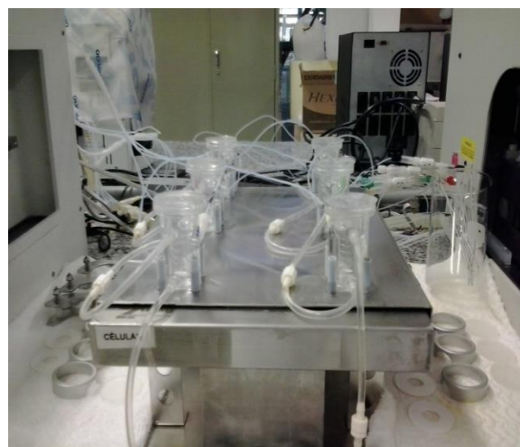
Figura 6- Fotos do equipamento Microette Plus-Hanson Research ® empregada nos estudos de liberação e permeação cutânea in vitro.
