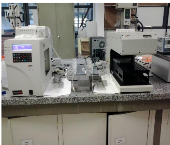
Figura 6- Fotos do equipamento Microette Plus-Hanson Research ® empregada nos estudos de liberação e permeação cutânea in vitro.
