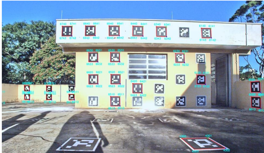
Figura 12– Alvos utilizados para realizar a calibração das câmaras - FCT/UNESP – Presidente Prudente – SP
