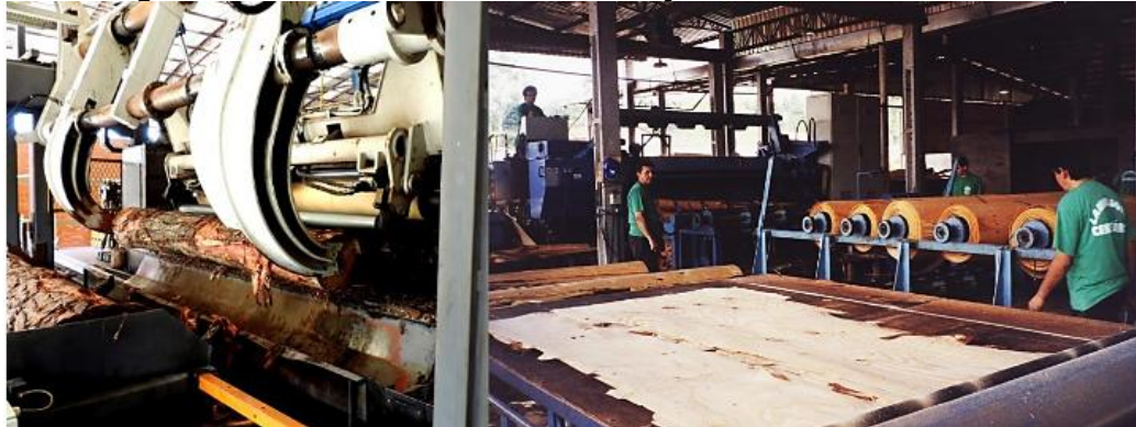
Figura 5 e Figura 6 - O descascador e a obtenção das folhas no torno laminador
