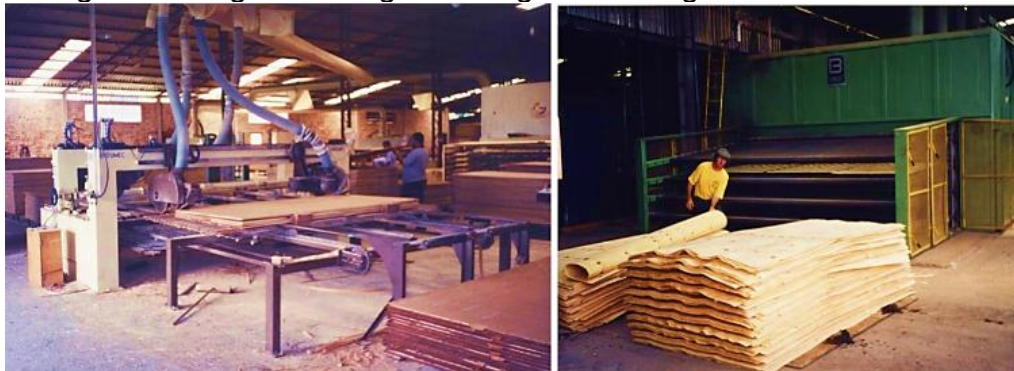
Figura 7 e Figura 8 - A guilhotinagem e secagem das folhas
