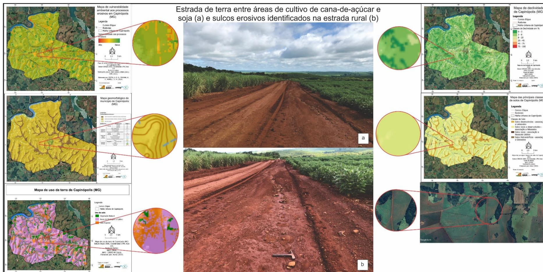
Figura 82: Estrada de terra entre áreas de cultivo de cana-de-açúcar e soja (a) e sulcos erosivos identificados na estrada rural (b)
