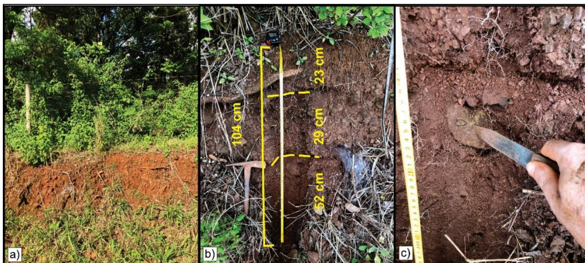
Figura 57: a) talude de Neossolo e a presença de vegetação natural; b) perfil de Neossolo Litólico; c) basalto fortemente intemperizado. Fonte: Fotografia dos autores (2021).
