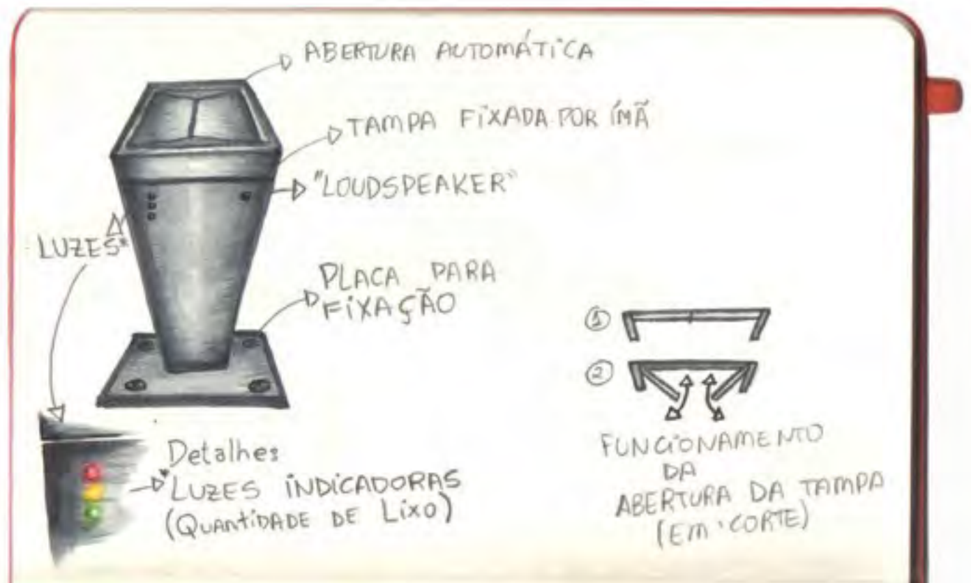
Esboços do funcionamento da lixeira
