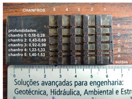
Figura 2.9. Chapa de Aço após Soldagem [Elaborado pelo Autor].
