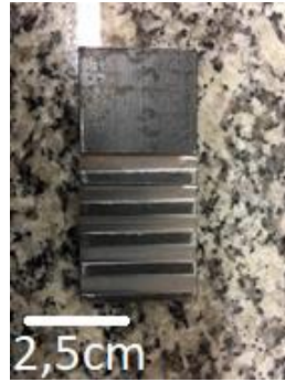
Figura 2.6. Metal Base Preparado com chapa metálica [Elaborado pelo Autor].
