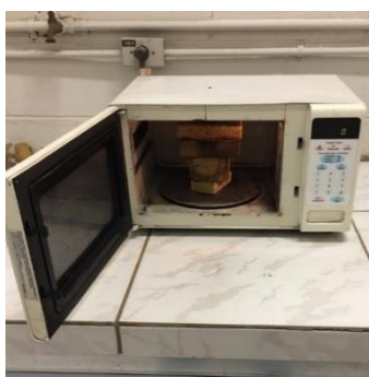
Figura 2.2. Micro-ondas utilizado no processo de fragilização [Elaborado pelo Autor].
