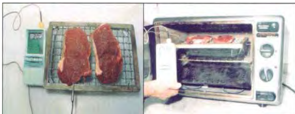
Figura 2 - Termoacoplador inserido no centro da amostra. E cozimento da carne em forno.
