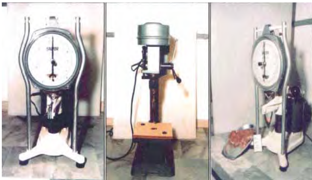
Figura 3 - Aparelho de Warner Bratzler Shear Force -Maciez da carne
