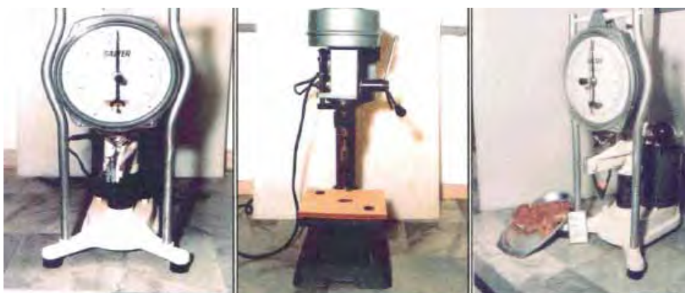
Figura 1 - Aparelho de Warner Bratzler Shear Force -Maciez da carne
