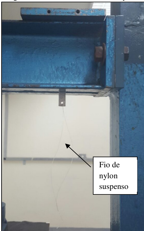
Figura 26: Detalhe do fio de nylon.
