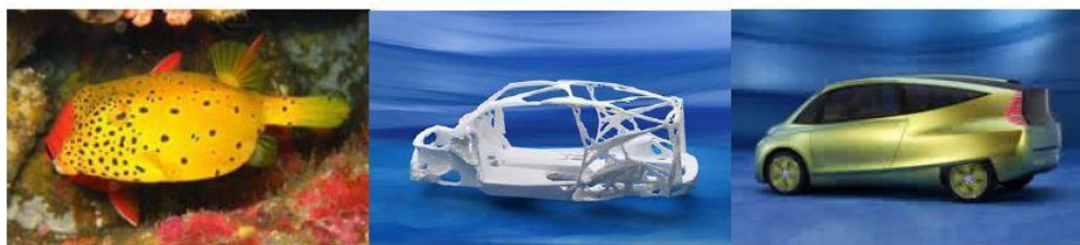
Figura 14 – Peixe-cofre (esquerda), Monobloco (centro) e automóvel Boxfish (direita).
