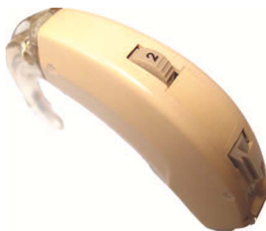
Figura 1.2: Aparelho auditivo que amplifica os sinais de audio, por meio de dispositivos semicondutores.
