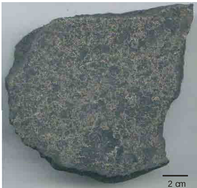
Figura 15 - Amostra de Minério Brechóide Tipo BR2 com clastos irregulares de serpentinito (preto) envolvidos por uma massa de sulfetos (amarelado).
