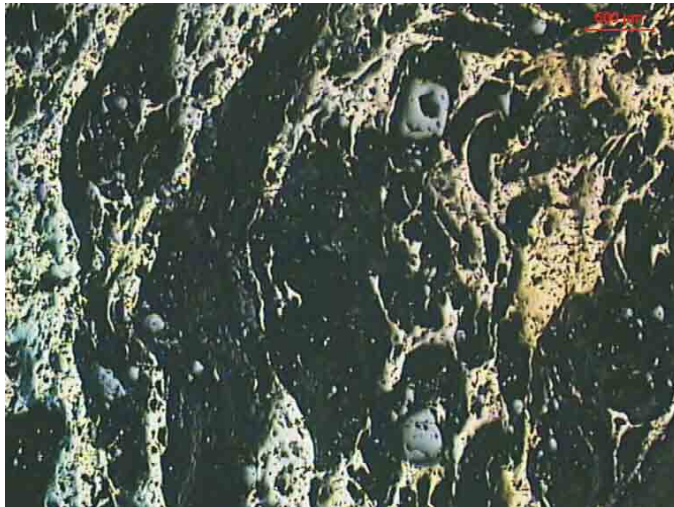
Figura14 -Fotomicrofotografia do Minério Brechóide Tipo BR1. Observa-se uma matriz sulfetada composta predominantemente por pirrotita (rosa claro)e pentlandita (amarela). A magnetita localiza-se no interior dos clastos de serpentinito.
