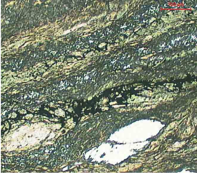
Figura 11 - Fotomicrofotografia da Formação Ferrífera Bandada evidenciando uma alternância de bandas de cummingtonita (castanho) e bandas de ferroactinolita (verde) com a presença de sulfetos associados. Destaca-se a presença de cristais de quartzo deformados (branco) em matriz de anfibólio. Fotomicrografia com nicóis cruzados.
