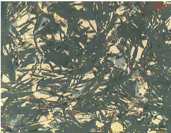
Figura 12 - Fotomicrofotografia mostrando o minério disseminado com textura de intercrescimento entre os sulfetos pirrotita (rosa claro) e pentlandita (amarela), magnetita (cinza) e serpentina (preto).
