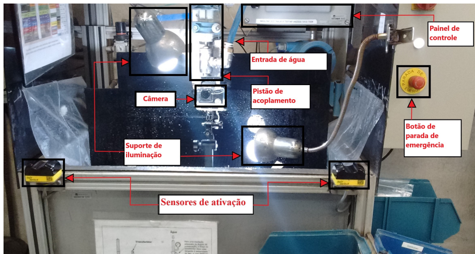
Figura 2.1: Vista geral da bancada de teste de vazão utilizada na caracterização do spray
