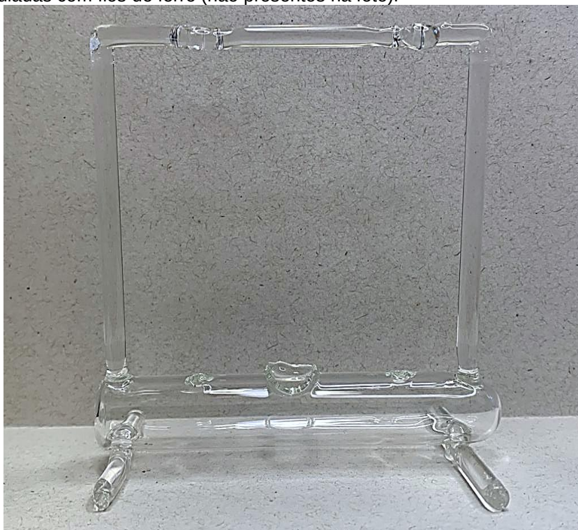
Figura 11: Vidraria produzida para simulação do contexto observado na janela da cela. As barras de ferro foram simuladas com fios de ferro (não presentes na foto).
