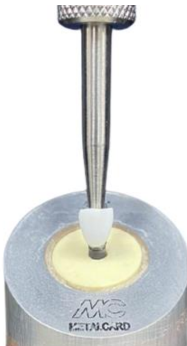
Figura 11 – Amostra fixada em base com 30° de angulação em relação ao solo (ISO 14801:2016)
