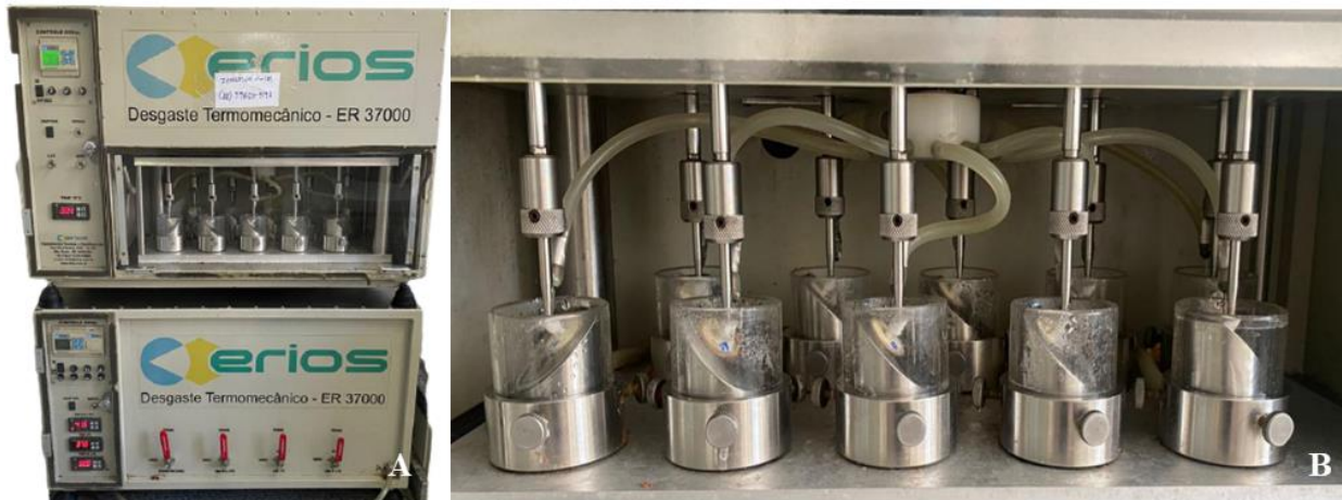
Legenda: A) Cicladora termomecânica (ER 37.000 Plus, Erios); B) Espécimes imersos em água destilada a 37 °C, sobre realização de teste de ciclagem termomecânico. Fonte: Elaborada pelo autor.
