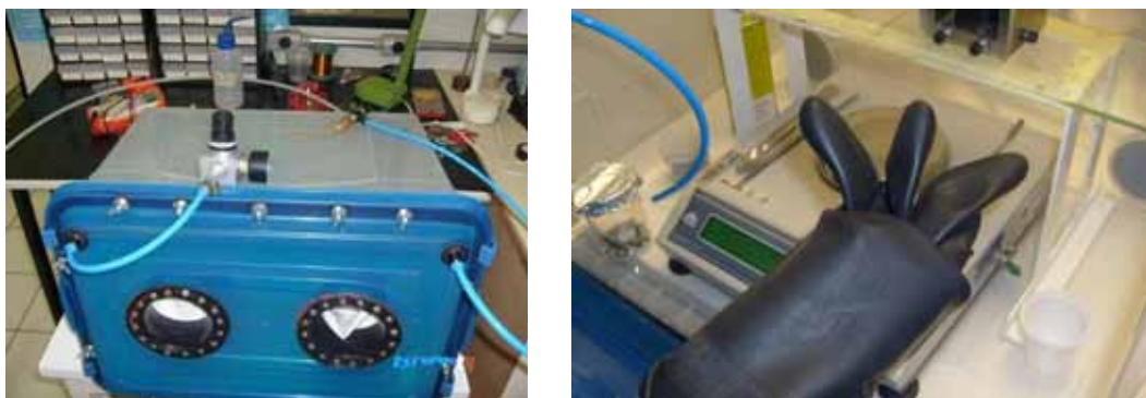
Figura 3.1: Caixa seca com atmosfera inerte. À direita, visão do seu interior.
