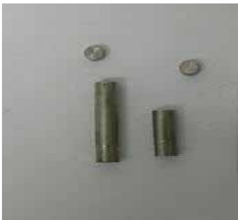
Figura 3.2: Tubos de aço inoxidável de dois comprimentos: 20 mm e 35 mm.
