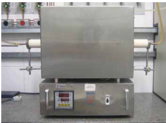
Figura 3.4: Forno cilíndrico utilizado para a preparação do diboreto de magnésio.
