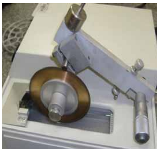
Figura 3.6: Remoção da amostra por meio de serra de baixa velocidade.
