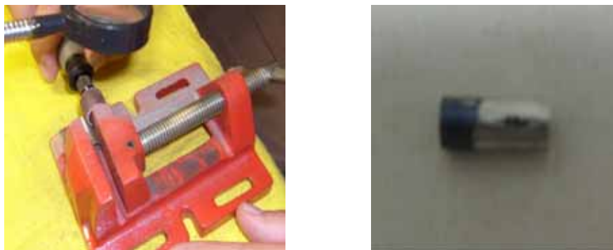
Figura 3.5: Desbaste dos tubos de aço inox contendo as amostras.
