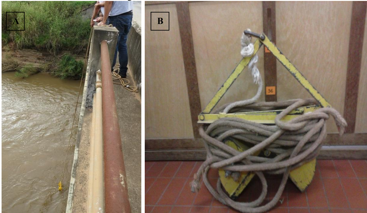
Figura 18 – Procedimentos para a coleta de sedimentos de fundo. A: Coleta dos Sedimentos; B: Draga Van Veen
