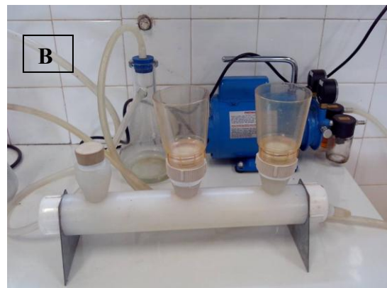
Figura 20 – Equipamentos utilizados para análise de sedimentos em suspensão. A: Mufla; B: Aparato para filtração e bomba a vácuo.
