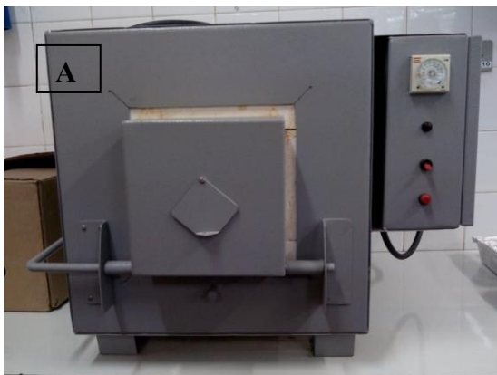
Figura 20 – Equipamentos utilizados para análise de sedimentos em suspensão. A: Mufla; B: Aparato para filtração e bomba a vácuo.
