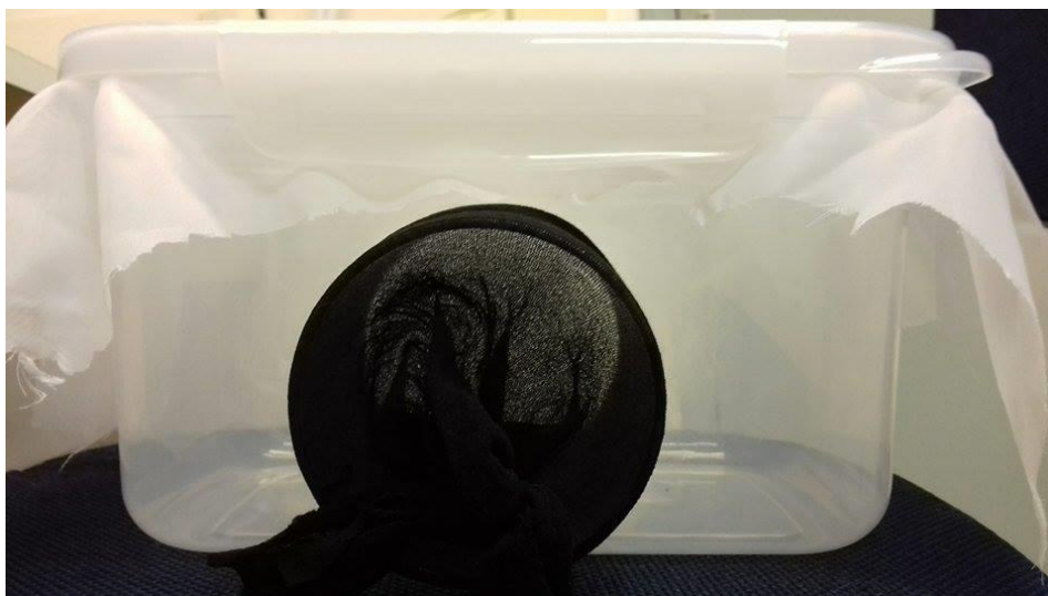
Figura 3- Recipiente utilizado para realização dos experimentos com adultos. A saída circular é por onde os indivíduos eram colocados e retirados.
