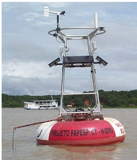
Figura 26 – Estação SIMA composta por uma boia toroidal de fibra de vidro (INPE, 2014)
