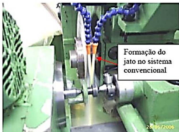
Figura 2.12. Representação da utilização de fluido de corte em abundância.
