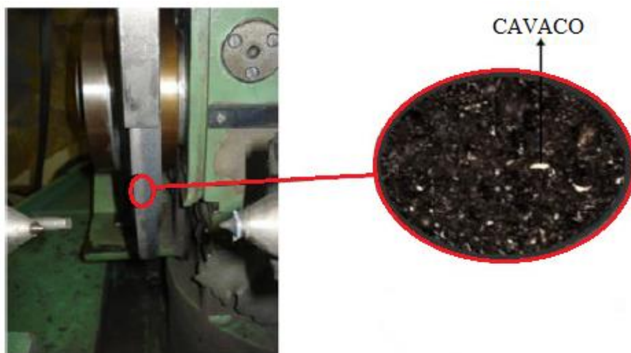
Figura 2.13. "Borra" composta de óleo e cavaco.
