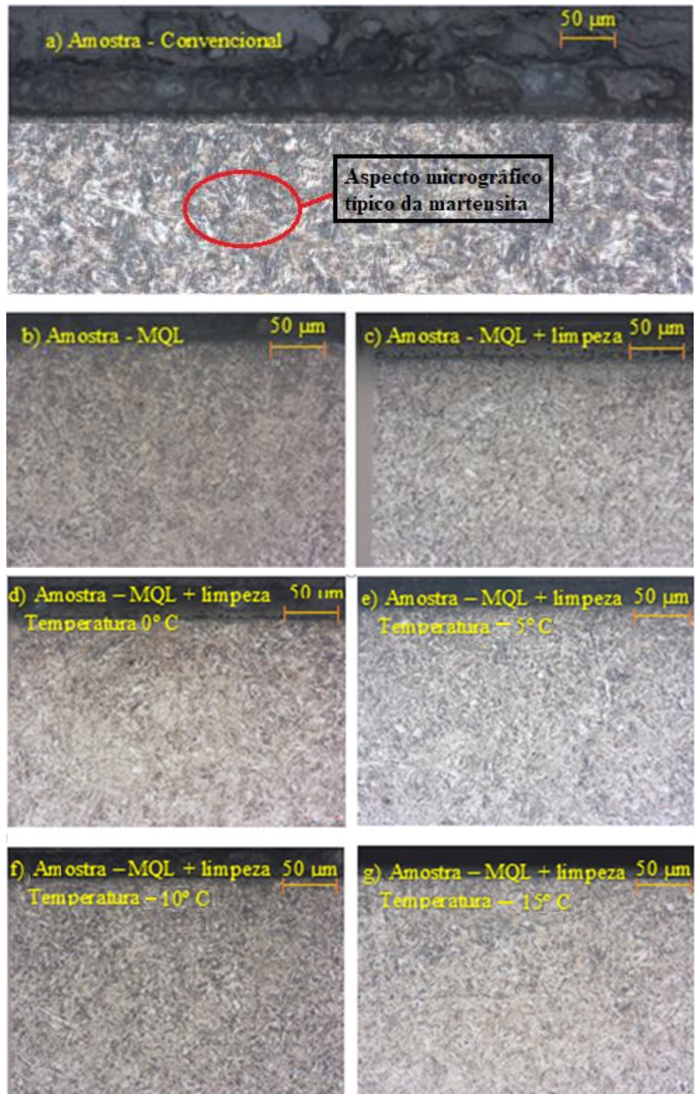
Figura 4.8. Micrografia do aço ABNT 4340 após retificação com as técnicas: a) convencional, b) MQL c) MQL com limpeza, d) MQL com limpeza à temperatura de 0° C, e) MQL com limpeza à temperatura de 5° C, f) MQL com limpeza à temperatura de 10° C, g) MQL com limpeza à temperatura de 15° C.
