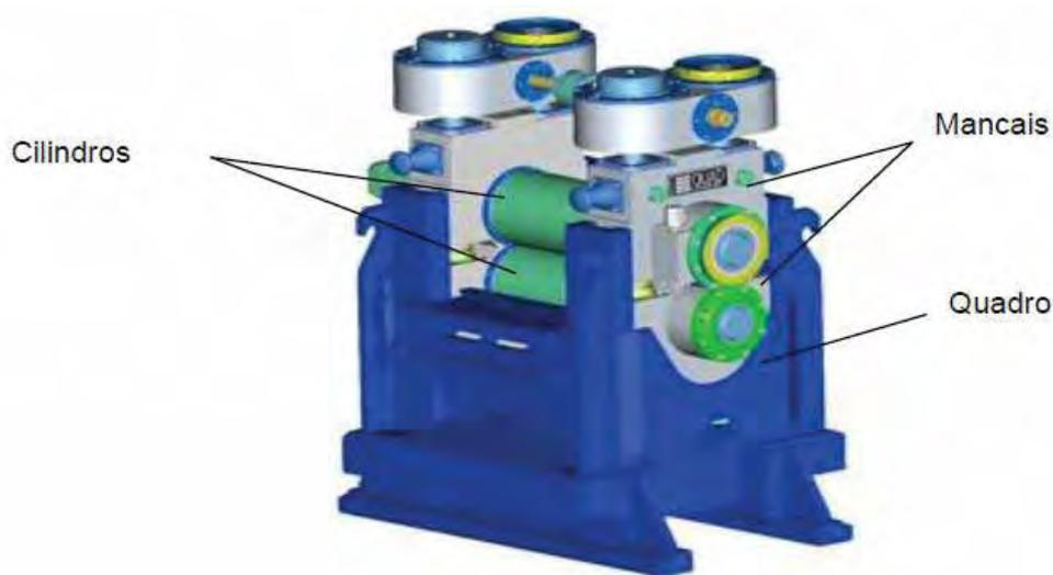
Figura 3 - Esquema de peças de um laminador. (Fonte: XAVIER, 2010).
