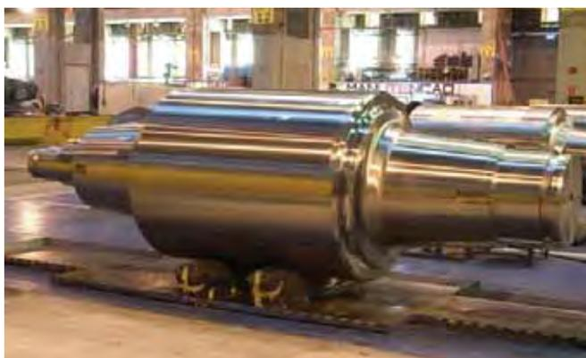
**Figura 4 – Exemplo de cilindro forjado. (Fonte: Autor).**
