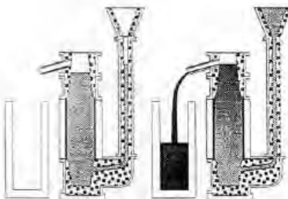
**Figura 10 - Esquema de fundição convencional. (Fonte: CORNÉLIO, 2006).**
