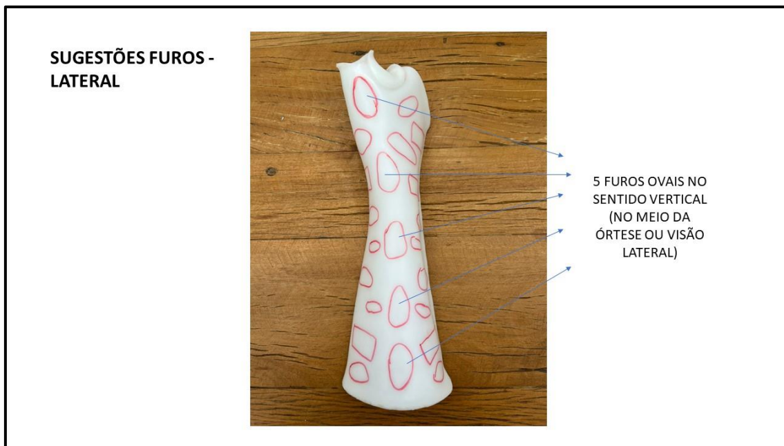
Figuras 29A, 29B e 29C. Slides em Power Point apresentando demais modificações a serem realizadas na órtese através de modelagem 3D Fonte: A autora, 2023
