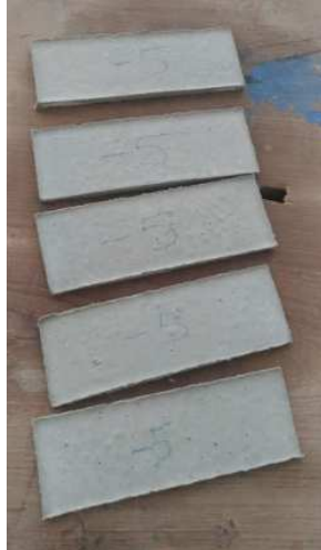
Figura 13: Corpos de prova para o ensaio de flexibilidade à baixa temperatura, já desformados
