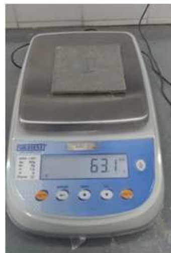
Figura 11: Corpos de prova para o ensaio de absorção (a) Corpos de prova da argamassa m1 curados e (b) sendo pesados
