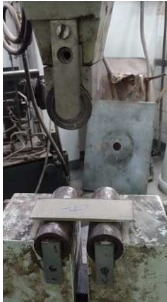
Figura 16: Detalhe do ensaio do corpo de prova para a temperatura de -10^{\circ}\text{C}
