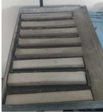
Figura 7: Corpos de prova com tamanhos adaptados para a máquina de tração
