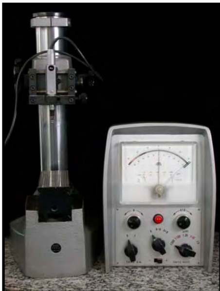
FIGURA 7 – Equipamento de medida que registra as alterações lineares.
