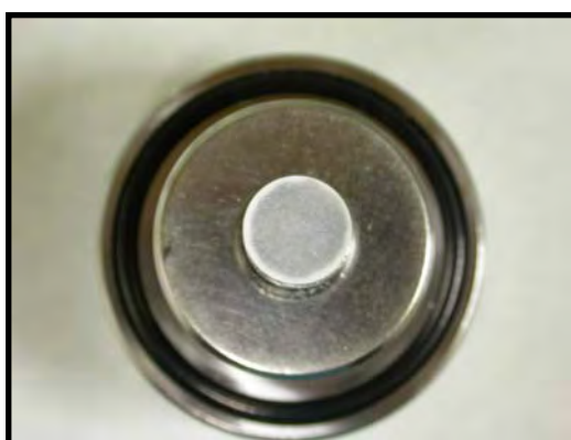
FIGURA 18 – Pastilha obtida após a desmontagem do pastilhador.
