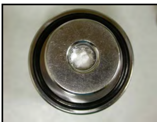
FIGURA 15 – Pó de resina misturado ao brometo de potássio e colocado no dispositivo de confecção da pastilha (pastilhador).
