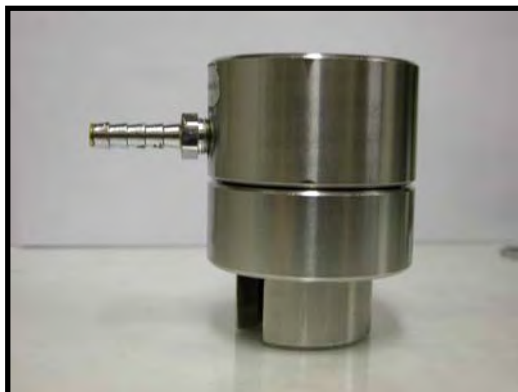
FIGURA 16 – Pastilhador montado contendo os pós em seu interior e pronto para ser levado à prensa.
