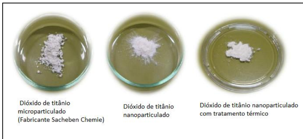
Figura1 – Foto do \text{TiO}_2 de uso comercial, do xerogel obtido através do processo sol-gel com e sem tratamento térmico
