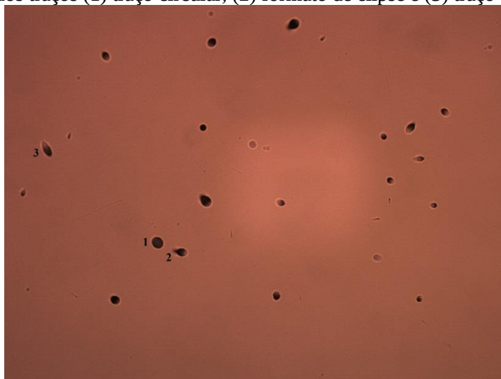
Figura 19: Imagens de traços das partículas no detector CR-39 em aumento microscópico de 500 x indicando formatos dos traços (1) traço circular, (2) formato de elipse e (3) traço alongado.
