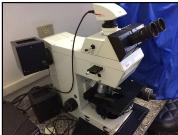
Figura 15: Sistema de microscopia utilizado para a contagem de traços nos detectores CR-39.
