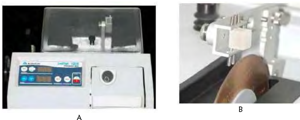
FIGURA 1 – Máquina recortadora ISOMET-BUEHLER: (A) visão geral da máquina; (B) detalhe dos dispositivos para fixação e corte, com o disco diamantado utilizado.
