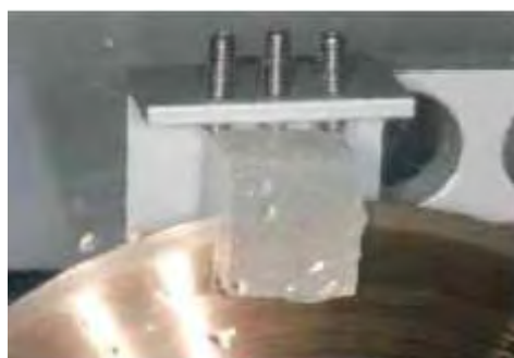
FIGURA 2 – Bloco de resina com implante sendo seccionado.
