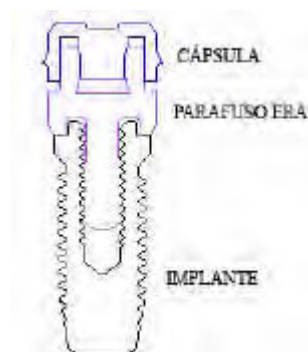
FIGURA 3 - Implante com sistema de retenção ERA Sterngold modelado no AutoCAD 2000, após digitalização.
