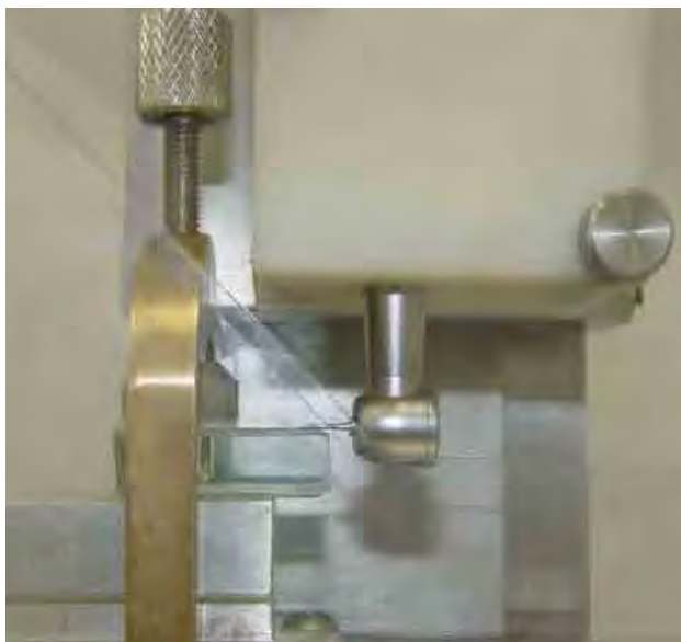
FIGURA 2 – Posicionamento inicial da fresa em relação ao substrato de desgaste.
