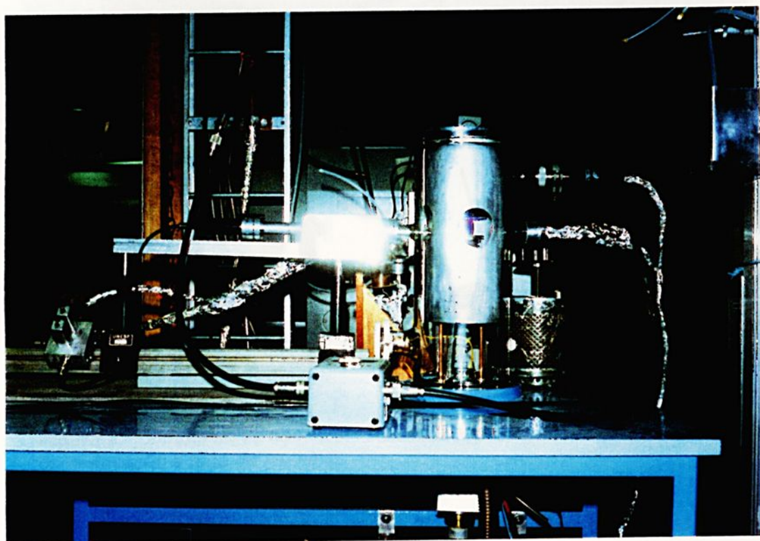
Figura 7 - Reator de processamento a plasma, em operação com argônio, cuja alimentação foi feita por radiofrequência. Observe que acoplado ao reator estão instrumentos de medida e coleta de dados.
