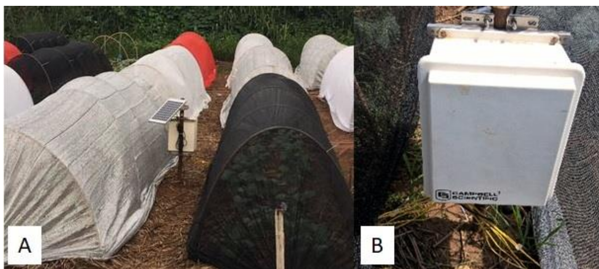
Figura 6. Vista geral da estação meteorológica (A) e vista parcial do datalogger (B) instalado entre os diferentes ambientes tipo telado e campo aberto para o cultivo da couve. Botucatu, FCA-UNESP, 2018.
